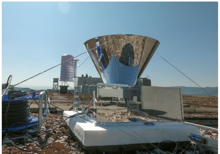
Der Pilot-Kondensator auf einem Gebäude der ETH Zürich
